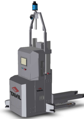
Fig. 1. A palletizer AGV.
